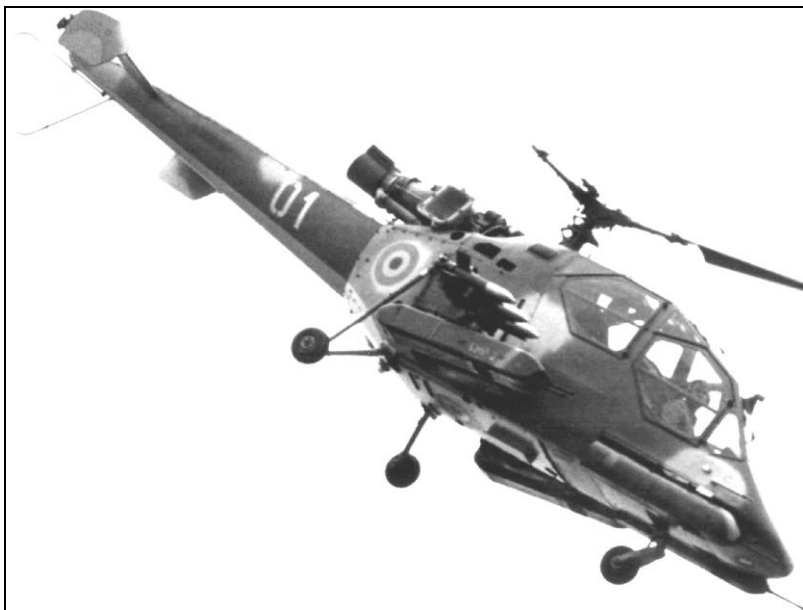
Prototipul elicopterului IAR-317 Airfox pe timpul unui zbor de testare; de remarcat armamentul montat pe elicopter (rachete antiblindaj Maliutka și tunuri containerizate)
