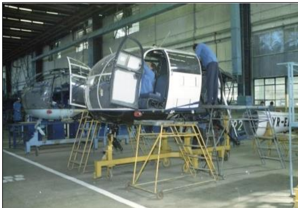
Pe linia de montaj elicopter IAR 316B Alouette III
