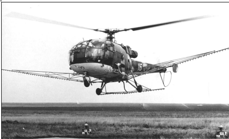
IAR-316B cu numărul de înmatriculare 16 dotat cu instalația de tratament aviochimic al culturilor
